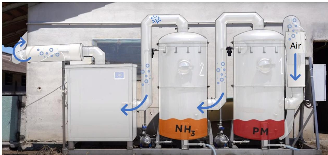
Figura 4. Prototipo di scrubber acido ad umido
